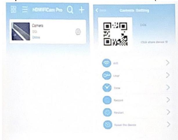
2. Změna WiFi připojení aplikace: Vyberte možnosti "Wifi settings" a zobrazí se dostupné WiFi hotspoty. Vyberte síť, vložte heslo a stiskněte tlačítko "finish" pro připojení. Poznámka: Po uložení, pokud se kamera připojí k wifi, odpojí se od předchozího připojení. Toto může způsobit krátkodobý výpadek zobrazení.
